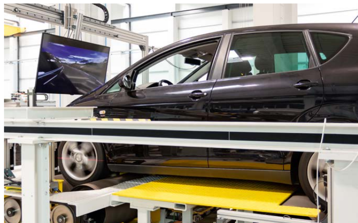
Autokino mal anders: Getestet wird die Reaktion des Autos auf die eingeblendeten Verkehrssituationen. Gerade beim autonomen Fahren ist sie besonders wichtig.
