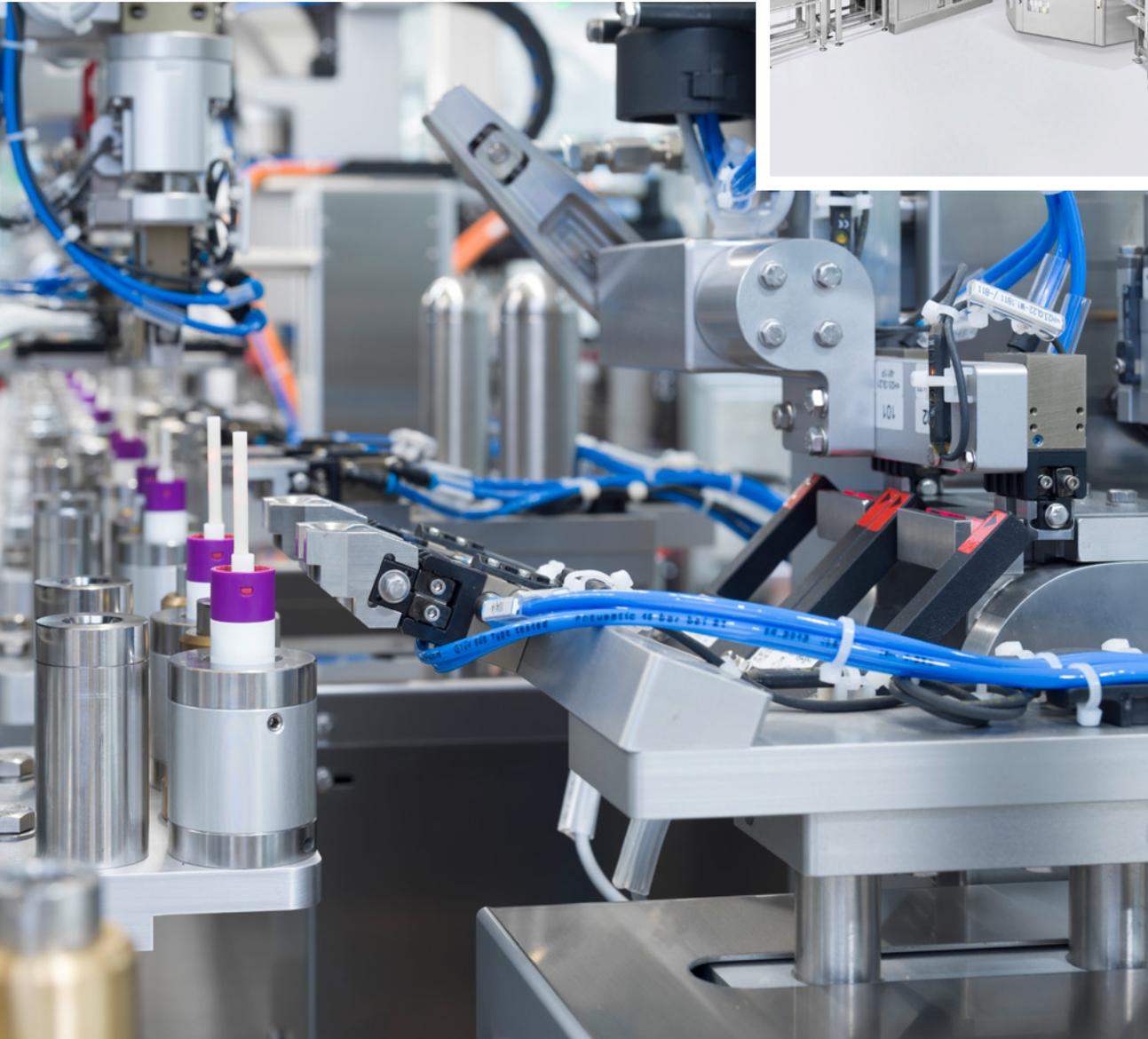
der Medizintechniksparte von Teamtechnik in Freiberg am Neckar. Typisch für diese Anlagen ist ein Transportsystem, das jedes Werkstück im Kreis von einer Arbeitsstation zur nächsten befördert. Eine bewährte Methode, die hochwertige Massenproduktion in kurzer Zeit ermöglicht.
