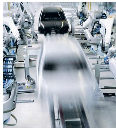
*Schnelle Transportzeiten zwischen den Prozessschritten erhöhen die Effizienz: Eco⊕Speed im Einsatz.*
