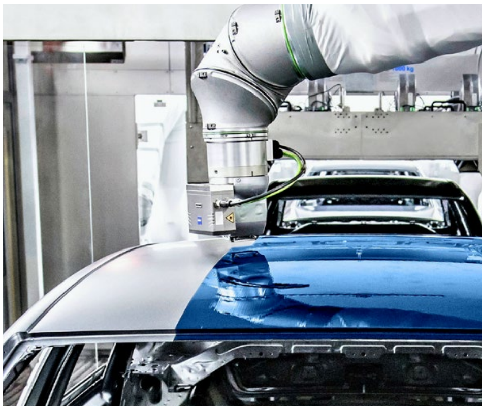
Kontrastlackierungen automatisiert und in Serie ohne Abkleben: Das EcoPaintJet-System trägt die zweite Farbe randscharf auf, was nicht nur Zeit, sondern auch Energie und Lack spart.
