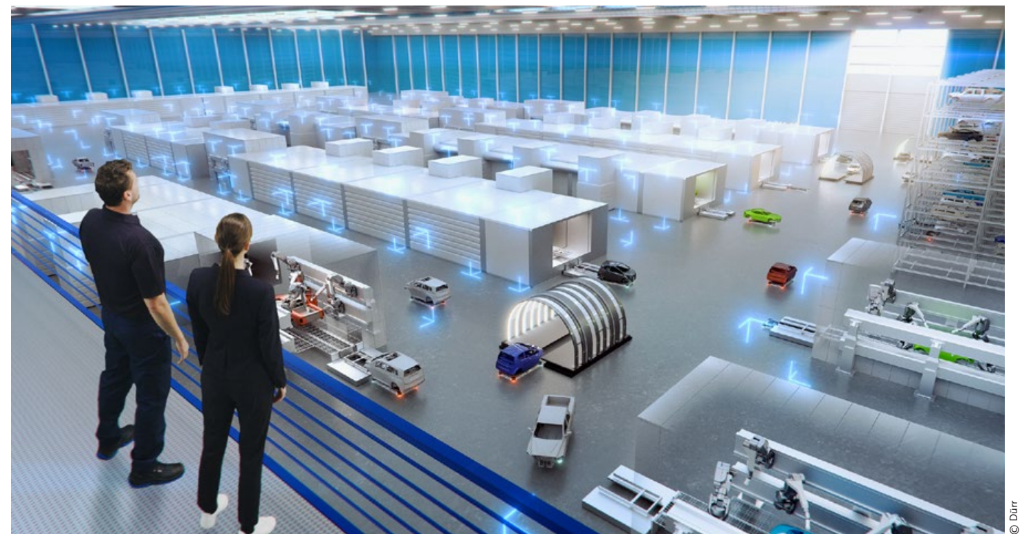
Maximal flexibel: Karosserien werden so durch die Lackierboxen geschleust, dass Totzeiten eliminiert werden. Das System ist leicht skalierbar.
