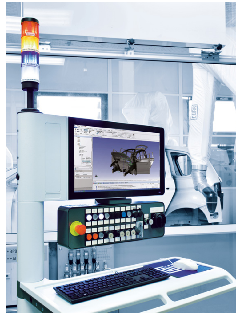
Das DXQ-Softwareportfolio ermöglicht eine lückenlose Aufzeichnung von Prozesswerten und Verbrauchsdaten in der Fertigung, die zukünftig mit Hilfe von künstlicher Intelligenz ausgewertet werden.
